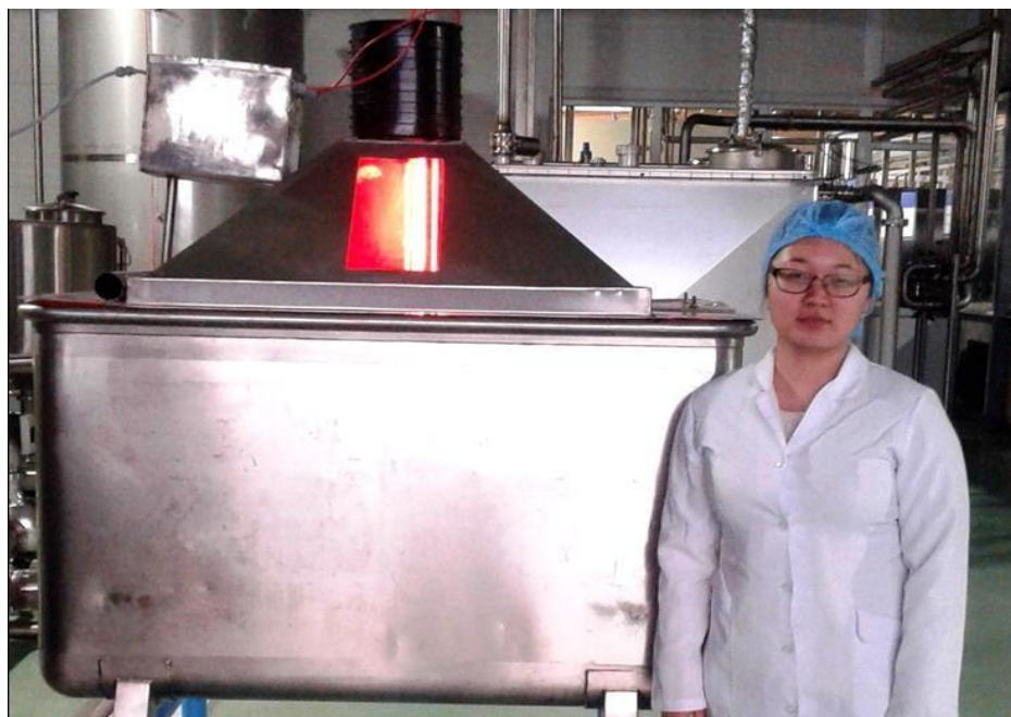
Рисунок 1 – Емкость для воды с гелий -неоновым источником монохроматического красного поляризованного света
