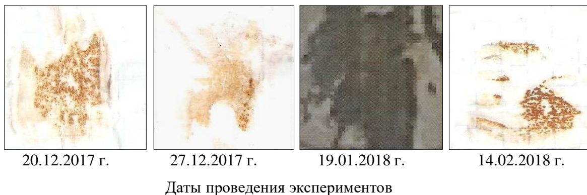
Рисунок 4 – Характерные налеты на металлических пластинах после контакта с активированной водой
