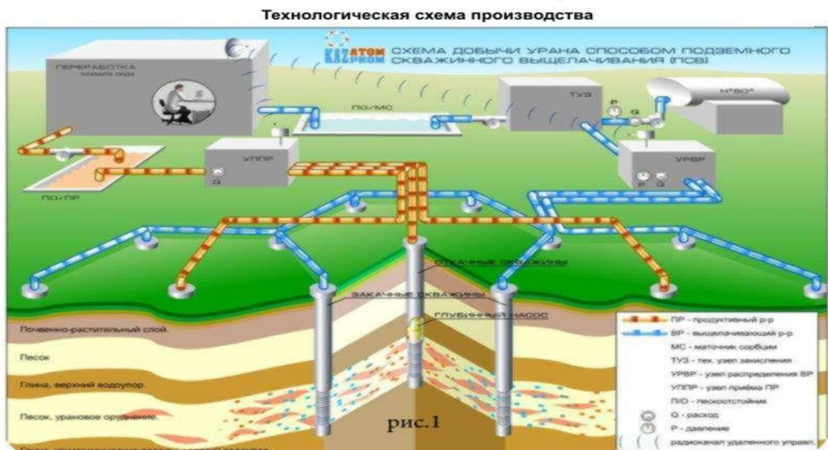
Рисунок 1 - Технология подземной добычи урана на месторождении «Семизбай»
